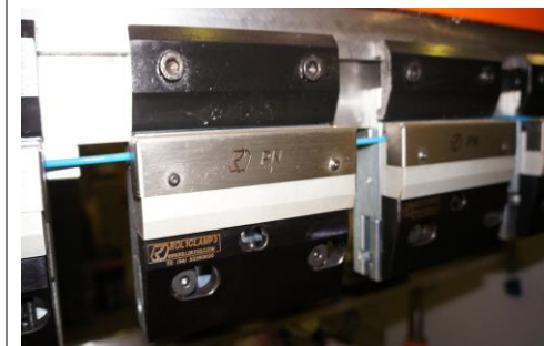
Intermediário de Aperto Pneumático de Punção com Saída Frontal.
