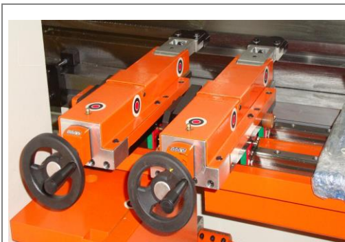
Tope Traseiro com Ajuste X5 Manual Montado Sobre Guias Lineares.
