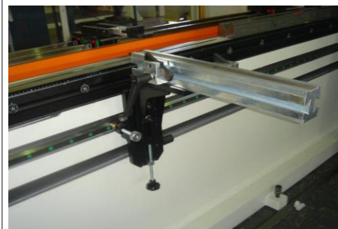
Braços de Apoio Frontal Deslizantes de 500 mm e 02 Topes Reguláveis.
