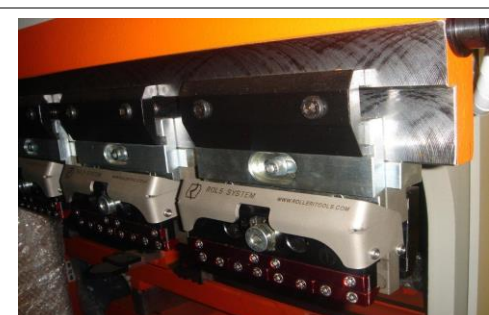
Intermediário de Troca Rápida Manual com Saída Frontal.
