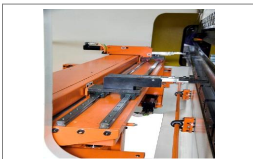
Tope Traseiro com Ajuste X5 Motorizado Controlado pelo CNC.
