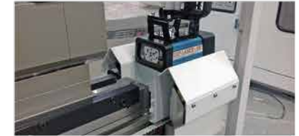
Sistema de seguridad frontal de acuerdo con la NR-12. Frontal Safety System according to NR-12.
