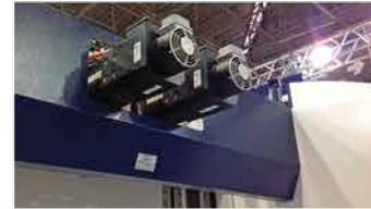
Servo motores de accionamiento, ejes Y1/Y2. Servo Motors for actuation of the axes Y1/Y2.
